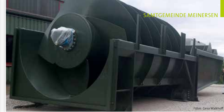
Die Wasserschnecke: 13 Meter lang, Durchmesser vier Meter, Leistung 112 kW.
